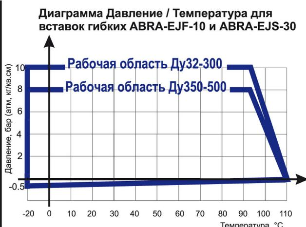
Диаграмма определяет рабочую область для вставок гибких фланцевых и резьбовых - антивибрационных компенсаторов в координатах Давление (в барах приборного) / Температура (° C).
